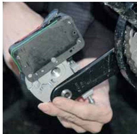
Frieder Herb und Kerstin Bünte im Testlabor Kirchheim/Teck. Vor allen Fahrten werden die Batterien der Elektroräder mit einem Stromsensor ausgestattet. Danach wird der Palm-Computer, der die Messdaten bei der Fahrt speichert, ausgelesen. Im Pedal befindet sich ein Widerstandsmessgerät.
