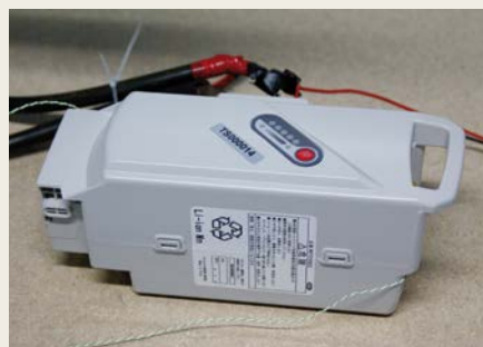
SICURO Il BMS (Battery Management System) si è rapidamente disinserito. Nella seconda fase l'elettronica è stata superata. Pertanto la batteria si è surriscaldata internamente oltre 100° C, raffreddandosi nuovamente. Sono fuoriusciti soltanto del liquido elettrolitico, ma non gas nè altri liquidi.
