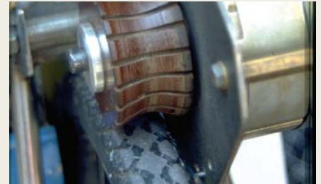
La trazione con frizione a rullo nella bicicletta a propulsione solare del pioniere russo della bicicletta ad energia solare Alexander Popolov nel 1989.
