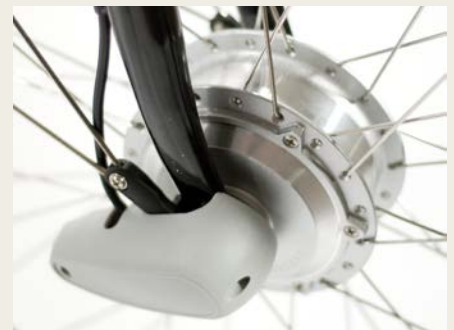
Il meccanismo d'avviamento Pedelec 25 più venduto in Europa nel 2011 – l'avviamento con motore sul mozzo dell'azienda cinese 8Fun.
