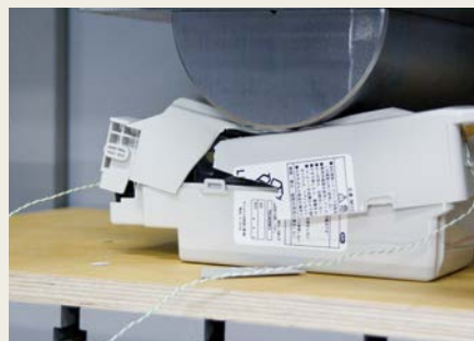
SICURO Distruzione meccanica della scatola della batteria, schiacciamento delle celle ma senza riscaldamento nè fuoriuscita di gas o liquidi.
