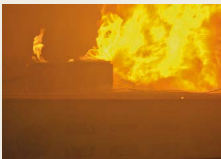
INCERTO Calore di fiamma eruttiva immediatamente dopo il cortocircuito.
