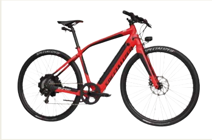
Specialized Turbo Pedelec 45. I componenti elettrici sono integrati ma non nascosti.
