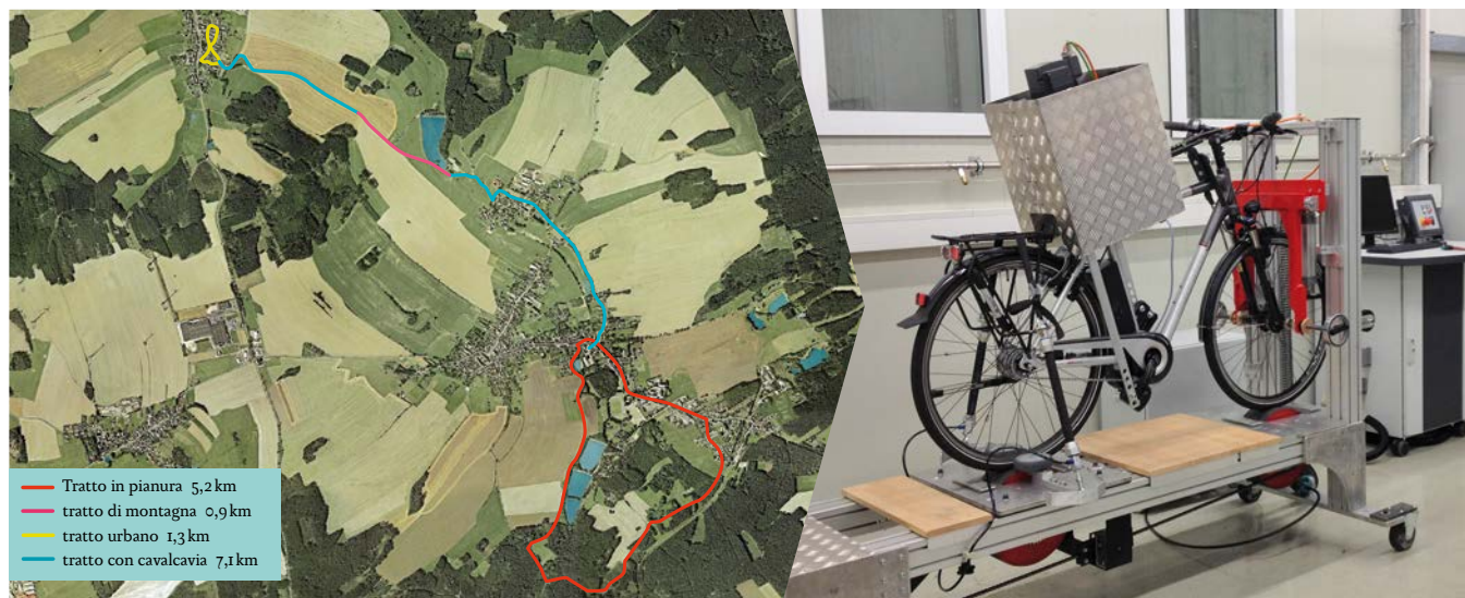
SINISTRA I tre tratti di prova della ExtraEnergy nel mondo reale: In pianura, in montagna, in città. La tecnica di misurazione ha valutato con estrema precisione i pedali e le mani durante i giri di prova fino al 2009. DESTRA Il collaudatore digitale è seduto in questo caso sulla strada digitale corrispondenti esattamente ai tre tratti stradali in Tanna: pianura, montagna e urbana. In tal modo chiunque, ovunque e con qualsiasi tempo meteorologico nel modo è in grado di svolgere giri di prova per poi confrontarne i valori ottenuti con grandi banche dati.
