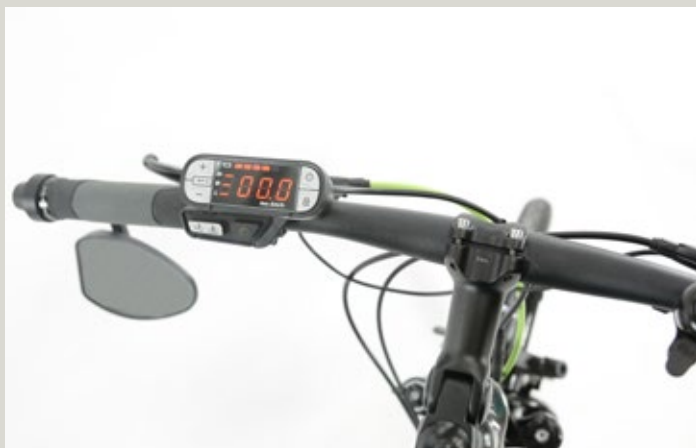
Funktional und optisch gelungen ist das Cockpit des Klever S45 mit unauffällig unter dem Lenker liegendem Rückspiegel. A functional and visually neat cockpit on the Klever S45, with a rear view mirror fitted unobtrusively below the handlebar.
