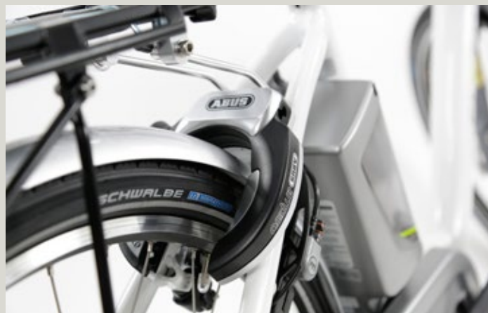
Für das Sichern gegen unerlaubtes wegfahren für zwischendurch – das Bügelschloss, welches den gleichen Schlüssel wie das Batterieschloss nutzt. To prevent the bike being ridden away unauthorised in unattended moments there's a frame lock, which uses the same key as the battery lock.
