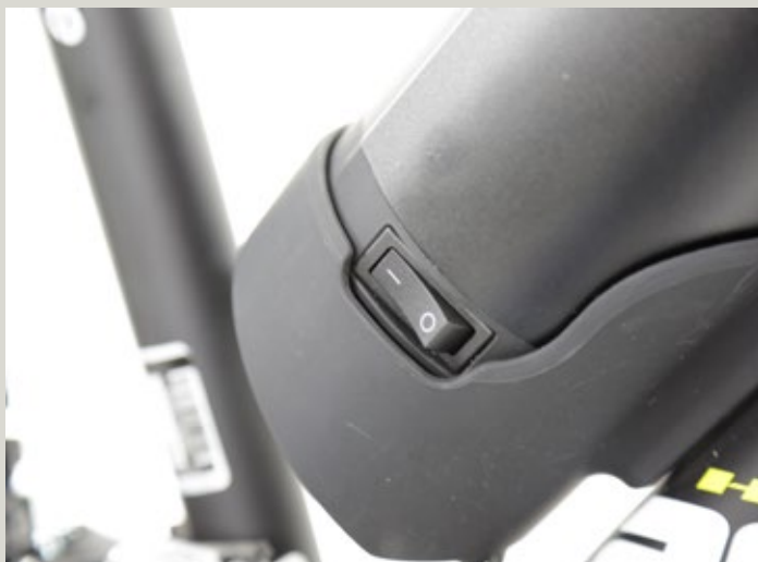
Nicht vergessen auszuschalten – die Trinkflasche mit Wippschalter. Don't forget to switch it off: a bottle cage with rocker switch.
