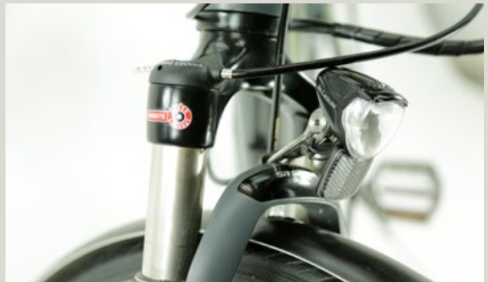
LED Beleuchtung, vom Lenker aus bedienbares Lockout der Federgabel und robuste Kunststoff-Radschützer sind Beispiele für die hochwertige auf Alltagsnutzen optimierte Ausstattung des Bergamont E-Line C-XT.
