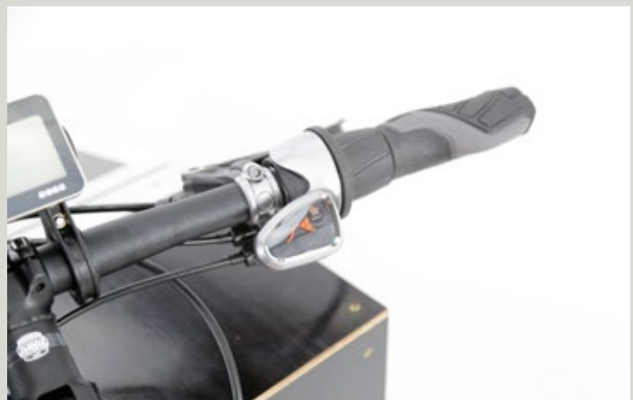
Die NuVinci Harmony bietet eine stufenlose Schaltung der Muskelkraft zusammen mit der Motorkraft des 8Fun Tretlagermotors. The NuVinci Harmony system provides stepless gear-changing for your pedal power, and for the motor power from the 8Fun crank drive.
