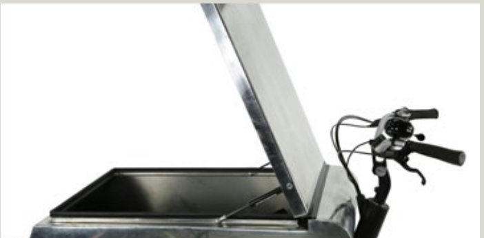
Im Detail sehr gut verarbeitet: Die große Aluminium-Transportbox des Urban Arrow . Dank der Gasdruckfedern lässt sich die Klappe leicht öffnen und schließen. Aufgrund der Konstruktion ist allerdings ein »Mischbetrieb« aus Kindertransport und Lastentransport ohne Umbau nicht möglich. When it comes to the details, the Urban Arrow 's large aluminium cargo box is very well crafted. Thanks to its gas spring the lid is easy to open and close. However, »mixed use« as both child and cargo transporter without making alterations isn't possible with this design.
