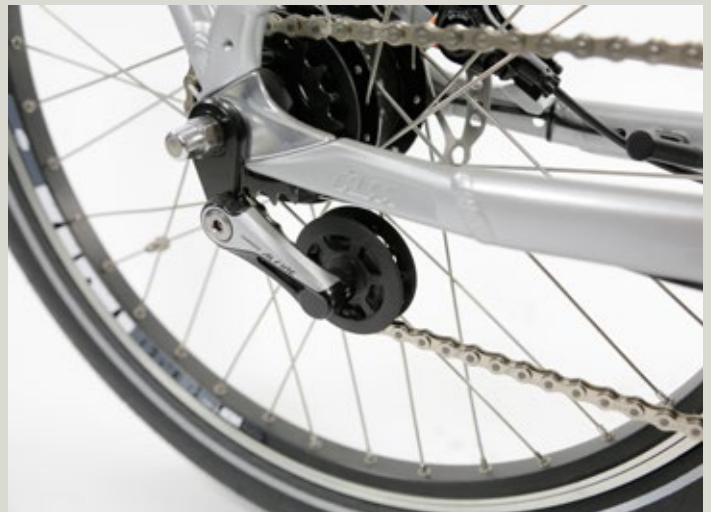
Eine große Spannrolle sorgt dafür, dass die Kette immer die richtige Spannung hat. A large jockey wheel ensures that the chain always has the correct tension.
