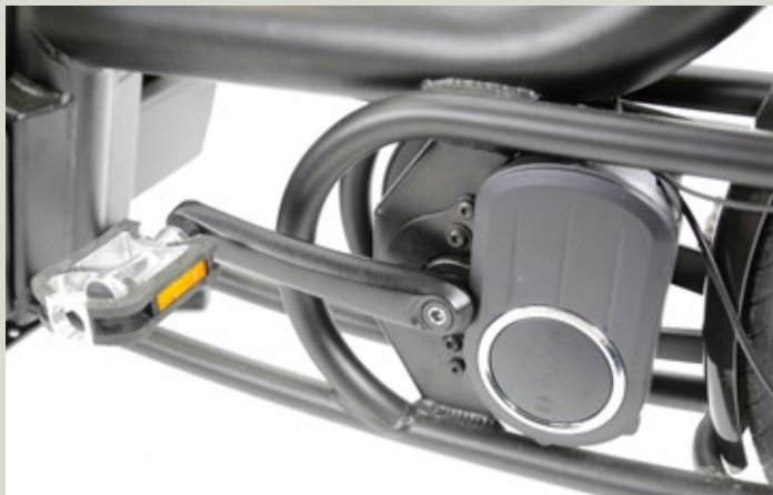
Tritt kräftig mit: Der Bosch Classic Mittelmotor, der im Urban Arrow hochkant eingebaut ist. Powerful pedalling via the Bosch Classic mid motor, mounted sideways on the Urban Arrow .
