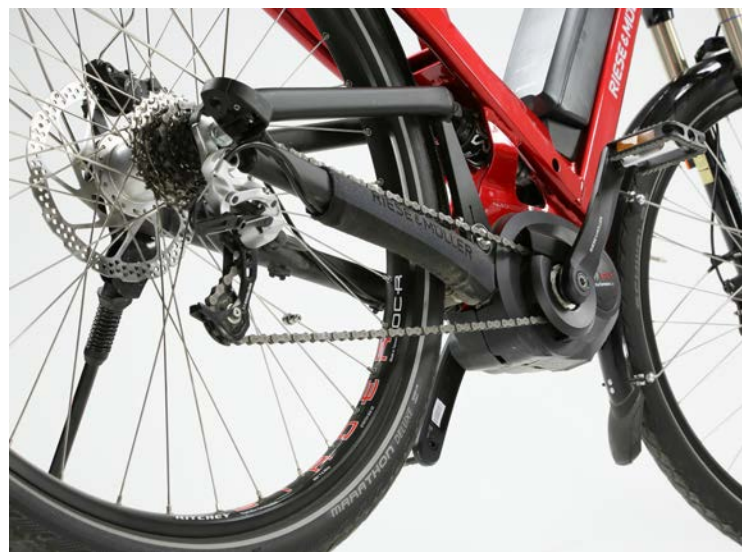
LINKS Ganz fett: Die Schwalbe Marathon Deluxe Reifen sind eine Mischung aus dem altbewährten Marathon und dem komfortabel dämpfenden Big Apple Reifen. Viel Federweg bringt die Suntour Aion Federgabel, die mit Steckachse und den bei Pedelecs 45 vorgeschriebenen orangenen Seitenreflektoren ausgestattet ist.
