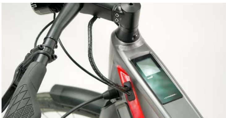
LINKS Was das Stromer ST2 S ausmacht, ist die konsequente Nutzung von Industrie-Schnittstellen: Hier im Bild die universelle Ladeschnittstelle gemäß der zukünftigen IEC Norm IEC 61851-3-2 / DIN IEC/TS 61851-3-2 (VDE V 0122-3-2). Im Stromer ST2 S wird aber auch GSM als mobile Internet-Anbindung, GPS zur Positionsbestimmung und Bluetooth zur Verbindung mit weiteren mobilen technischen Geräten genutzt.
