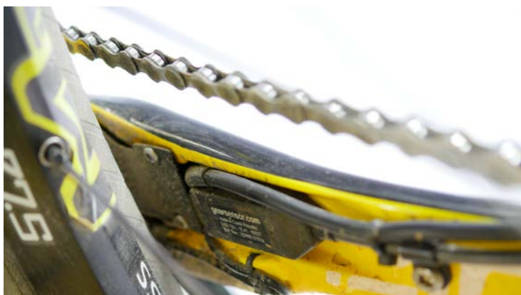
LINKS Typisch für M1 ist der kräftige TQ Mittelmotor, der das Sterzing Commuter MCF mit einem über alle Testräder einmalig hohen U-Faktor von 3,88 auf der Tourenstrecke vorantreibt. Die etwas klobige und unhandlich zu wechselnde Batterie muss nach rund 50 km auf der Tour wieder aufgeladen werden.
