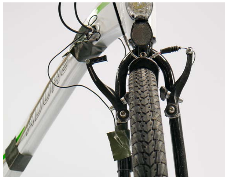
LINKS Der Rahmen soll offensichtlich elegant und geschwungen daherkommen. Daher ein aufwendig hergestelltes Rohr mit komplexer Form. Doch ein ganz normales rundes Rohr hätte vermutlich mehr Stabilität gebracht. Die Form des verwendeten Rohres bringt, ähnlich wie ein hochkant stehendes Brett, wenig seitliche Stabilität.
