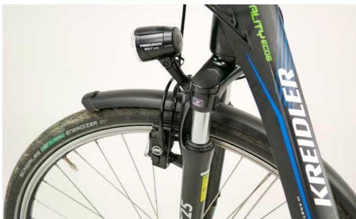
LINKS Am Kreidler Vitality Eco6 kann man beispielhaft schön sehen, dass die Komponentenhersteller das Pedelec immer ernster nehmen und spezifische Produkte dafür herstellen. Hier ist eine spezielle Pedelec 25 Gabel vom Weltmarktführer für Federgabeln im mittleren Preissegment verbaut sowie ein speziell für Pedelecs entwickelter Reifen von Schwalbe.
