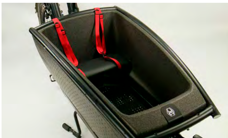
LINKS Die stabile und modular aufgebaute Plattform des Urban Arrows mit einem gutmütig-intuitiv zu lenkenden Fahrwerk. Beispielsweise für einen Handwerker bietet die Option, über das Jahr mit Kofferaufbau dienstlich damit zu fahren und es für den Urlaub, durch 20 minütigen Wechsel des Aufbaus, auf Kindertransport umzurüsten.
