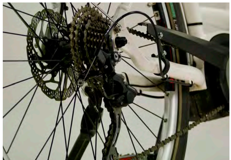
LINKS Ein Beispiel von vielen, welches zeigt, wie Carver beim Dancelli Wert auf Details gelegt hat. Der komfortable ergonomisch ausgeformte Griff ist mit geprägtem Kunstleder überzogen. Am Carver Dancelli finden sich einige Details, die für den sportlicheren Alltagseinsatz vorgesehen sind: Die Dämpfergabel mit Fernabschaltung vom Lenker aus sowie die Deore 10-Gang-Ketten-Schaltung.
