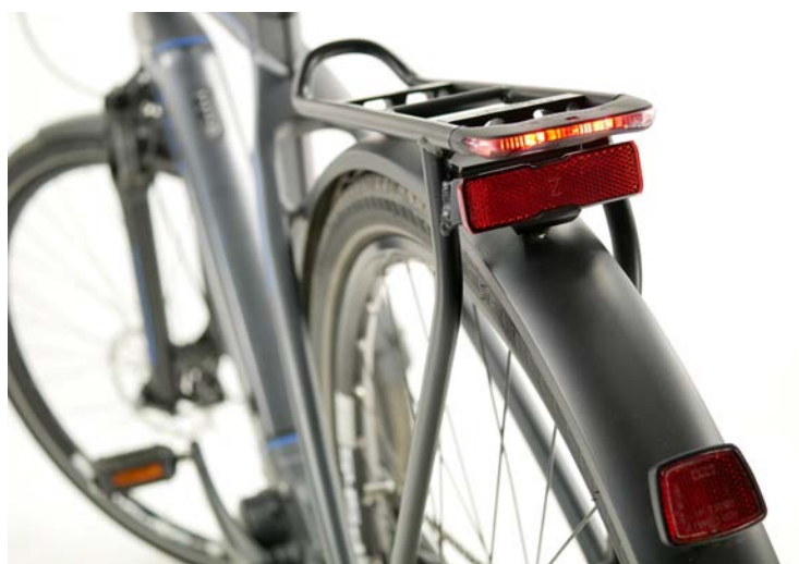
LINKS Hier klappert und wackelt nichts. Kalkhoff hat es bei diesem Modell geschafft, fast alle Hydraulikschläuche, Kabel und Bowdenzüge, die sonst den Lenkerbereich verunstalten, einfach verschwinden zu lassen. Massiv der Vorbau und massiv das Schutzblech aus einem Aluminium-Strangpress-Profil - mit dieser Technik werden auch die Felgen hergestellt.
