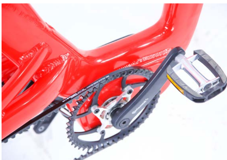
LINKS Der Rahmen ist beim Entz Deluxe dominant und tonangebend. Passenderweise hier im kontrastreichen rot. Kaum zu glauben, dass man solche fließenden Formen aus Rohren formen kann. In diesem Rahmenbau steckt sehr viel Hydroformung von Rohren, Fräsen von Rohren und Halbzeugen sowie viele, viele mit Hand gezogene Schweißnähte.
