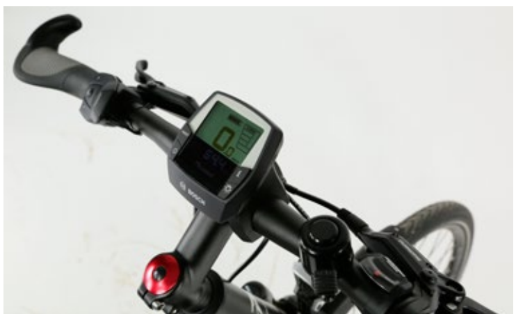
RECHTS Das Cockpit des Pegasus Premio E10 überzeugte dadurch, dass es hohe Funktionalität bietet und trotzdem nur mit den notwendigsten Komponenten für eine komfortable Bedienung ausgestattet wurde. Es ist nicht so überladen wie so manch anderes Cockpit. Die Hände dürfen sich auf den bequemen Ergon Griffen abstützen. Die Schultern und Handgelenke werden es einem danken, wenn man ab und zu mal die Position wechselt.
