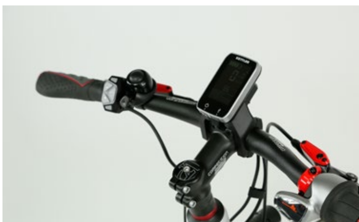
RECHTS Das Cockpit ist beim Kettler Boston , wie der Rest des Fahrzeugs, mit roten Farbakzenten versehen. Die Bedienerlogik des Panasonic Antriebs ist schnell erfasst und frei von unnötigem Schnickschnack. Praktisch ist die USB Buchse am Display, mit deren Hilfe man, wenn ein passendes USB Starthilfekabel vorhanden, die Batterie des stromhungrigen Smartphones wieder auffüllen kann.
