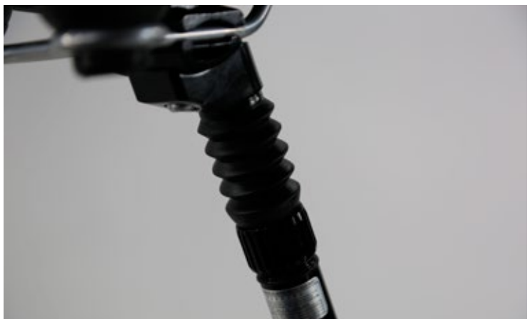
RECHTS Nicht so praktisch: die Federsattelstütze ist schnell defekt. Wenn die Rändelmutter zur Einstellung der Federhärte aus Versehen zu weit gedreht wird und aus dem letzten Gewindegang rutscht, ist sie für den Laien nicht mehr einsetzbar.
