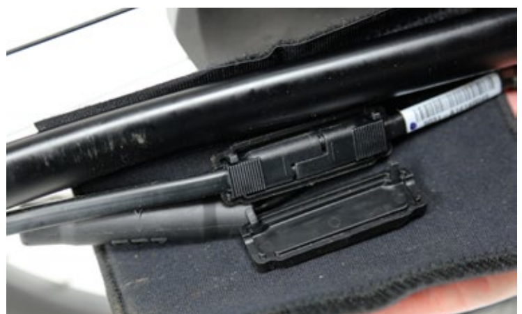
RECHTS Einfache aber effektive Lösung eines altbekannten Fehlerleufers - die Motorstromkabel rutschten bei den BionX Motoren gerne mal unbemerkt auseinander. Dies ist jetzt dank des Kunststoff-Umgehäuses, welches das ungewollte Öffnen des Steckers verhindert, nicht mehr möglich. Die Alternative wäre gewesen, einen Stecker mit einer Rastung einzusetzen.
