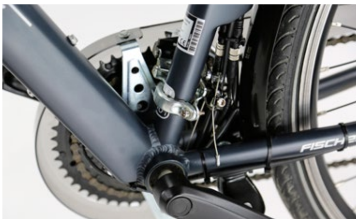
RECHTS Der Kabelbaum ist gut geschützt in den mit zwei Kammern ausgeführten Rahmenrohren verlegt. Die mechanischen Teile des Pedelecs, wie beispielsweise die Schaltung, sind eher einfach gehalten. Im Verhältnis zum getesteten Wettbewerber ist der Verkaufspreis jedoch auch deutlich günstiger.
