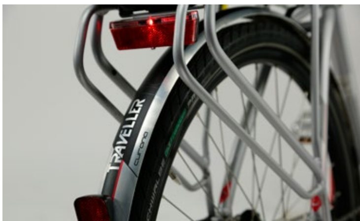
RECHTS Qualität im Detail: Stabiler Radschützer mit innenverlegtem Stromkabel des Bosch Antriebes, ein Trelock LED Rücklicht und der stabile Carrymore Gepäckträger sind Beispiele der funktionellen und hochwertigen Ausstattung des Kettler Traveller E-Light .
