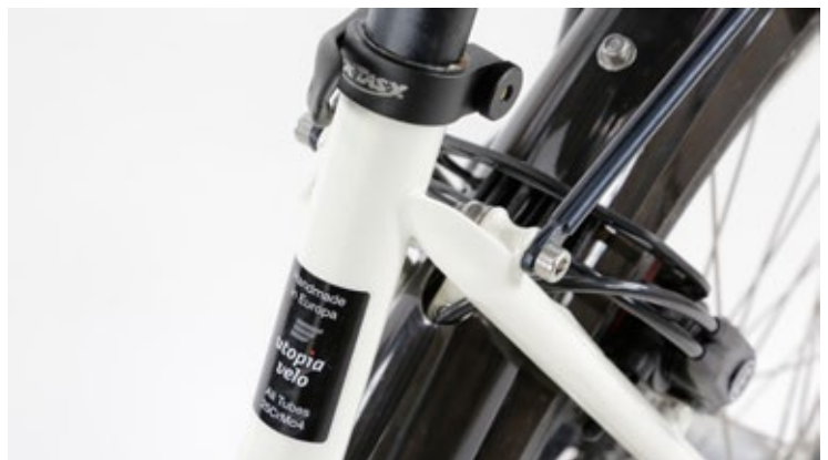
RECHTS Die nach heutigem Stil eher dünnen Rohre und Rohrverbindungen des Rahmens zeugen davon, dass hier Stahl als Rahmenmaterial zum Einsatz gekommen ist. Die Rohre sind aus hochfestem und doch elastischem Chrom-Molybdän-Stahl und werden in den Niederlanden in einer Manufaktur zum Rahmen verarbeitet. Heute etwas sehr seltenes.
