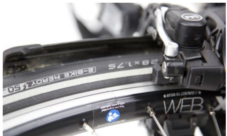
RECHTS Im Detail sieht man, wie Ansmann beim FC-1 Premium auf Sicherheit und Qualität geachtet hat. Leider immer noch nicht selbstverständlich ist die Verschleißanzeige der Felge. Wenn der schwarze Strich in der Mitte der Felgenflanke weg ist, dann sollte man schnellstens die Felgen tauschen lassen. Die Wandung wurde dann so weit heruntergebremst, dass die Stabilität nicht mehr gewährleistet ist.
