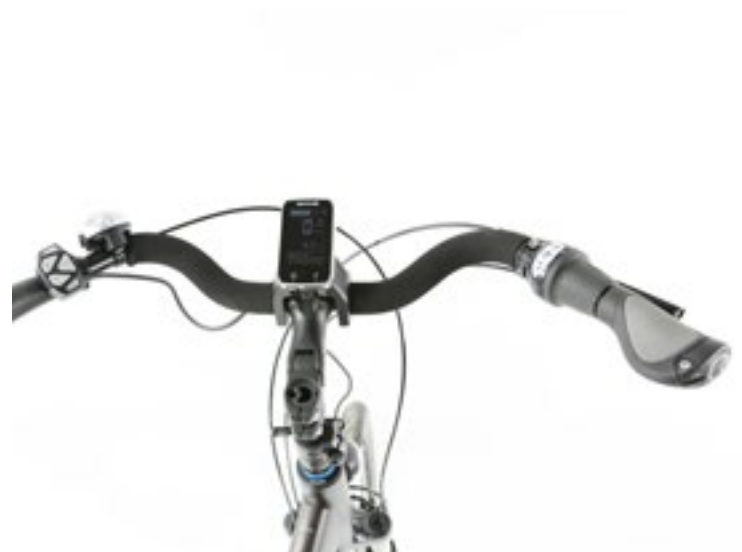
RECHTS Der Lenker lässt sich dank Speedlifter -Vorbau einfach und ohne Werkzeug in der Höhe anpassen. Die Bedienung der Schaltung und der elektrischen Unterstützung ist intuitiv. Lediglich die Klingel ist nicht ideal angebracht.
