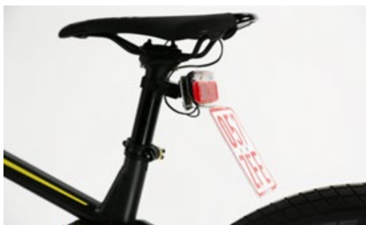
RECHTS Das Focus Thron hat einen unauffälligen Kennzeichenhalter, der zusammen mit dem Rücklicht am Sattelrohr angebracht ist. Für die, die damit ganz legal auf der Straße fahren wollen, ist das keine gute Lösung. Speziell bei kleineren Menschen kann das Kennzeichen schnell mit dem Hinterrad kollidieren. Auch beim Herausziehen der Sattelstütze droht Gefahr: Dabei kann das Stromkabel abgerissen werden, welches durch selbige geführt ist.
