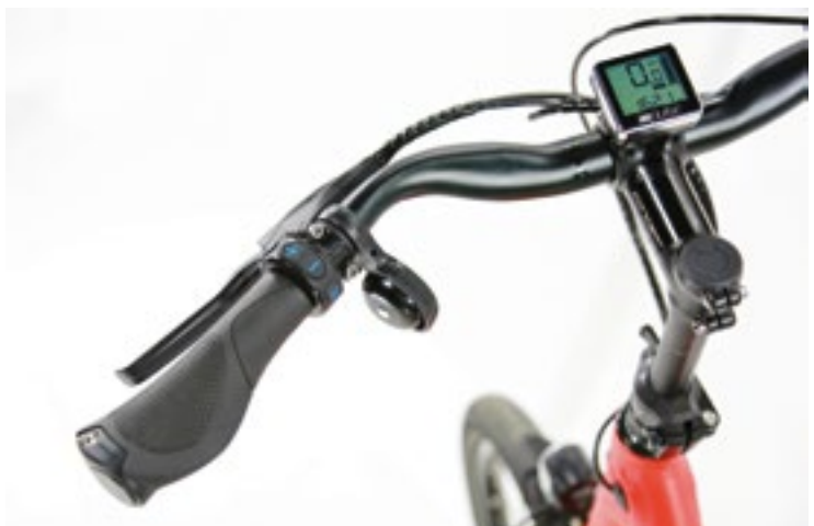
RECHTS Ganz viele vorbildliche Details an einem Lenker: Die leicht verständliche Fernbedienung des kleinen zentralen Displays beschränkt sich auf die zentralen Funktionen. Werkzeuglos erlaubt der Speedlifter mit »Querstellfunktion« sowohl die stufenlose Höhen- als auch die Querverstellung des Lenkers zum platzsparenden Transport.
