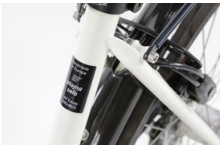
RECHTS Die nach heutigem Stil eher dünnen Rohre und Rohrverbindungen des Rahmens zeugen davon, dass hier Stahl als Rahmenmaterial zum Einsatz gekommen ist. Die Rohre sind aus hochfestem und doch elastischem Chrom-Molybdän-Stahl und in den Niederlanden in einer Manufaktur zum Rahmen verarbeitet. Heute etwas sehr seltenes.
