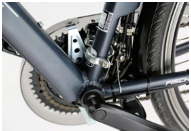
RECHTS Der Kabelbaum ist gut geschützt in den mit zwei Kammern ausgeführten Rahmenrohren verlegt. Die mechanischen Teile des Pedelecs, wie beispielsweise die Schaltung, sind eher einfach gehalten. Im Verhältnis zum getesteten Wettbewerb ist der Verkaufspreis jedoch auch deutlich günstiger.
