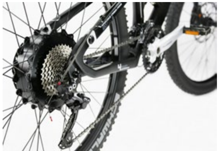
RECHTS Die kräftige Unterstützung wird vom GO SwissDrive Motor geliefert, der in der Hinterradnabe seinen Platz hat.
