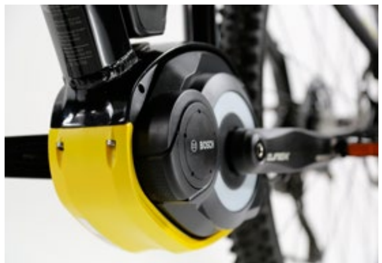
RECHTS Optisch und funktionell gelungen. Der etwas schwülstig in Kunststoff gekleidete Bosch Mittelmotor wird durch den Rahmen gefasst und optisch so zu dessen Bestandteil.
