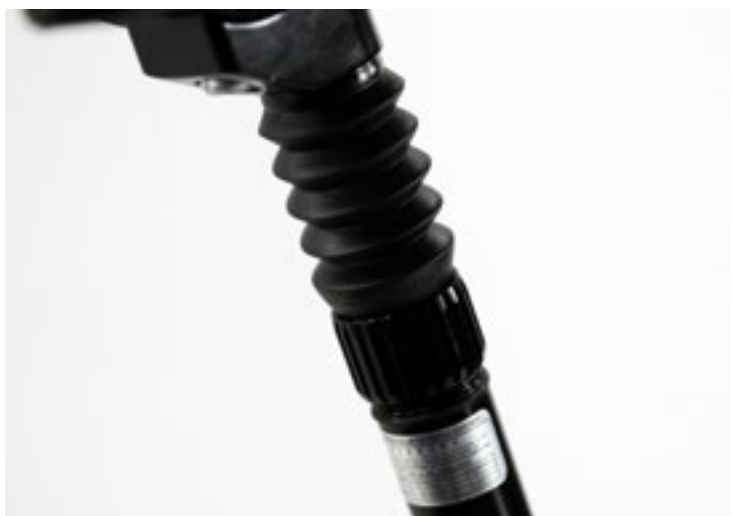
RECHTS Nicht so praktisch: die Federsattelstütze ist schnell defekt. Wenn die Rändelmutter zur Einstellung der Federhärte aus Versehen zu weit gedreht wird und aus dem letzten Gewindegang rutscht, ist sie für den Laien nicht mehr einsetzbar.
