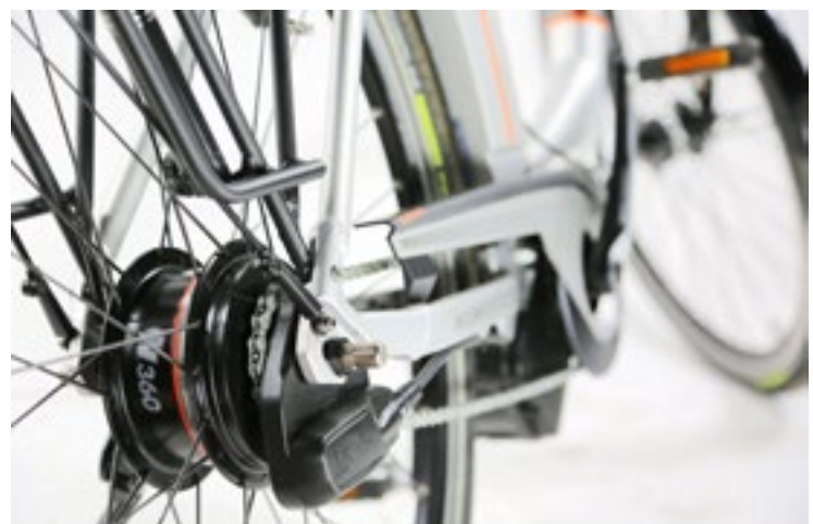
RECHTS Die stufenlose Nabenschaltung NuVinci Harmony , die die Trittfrequenz im automatischen Modus konstant halten kann.
