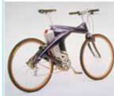
Das neue Axon von 1995 ist eine wichtige Neuentwicklung des Elektrofahrers. Es verkörpert die Idee des Pedelecs als kraftunterstütztes Fahrrad und zeigt optisch in der Fahrerzone seine »Intelligenz«. Das Fahrzeug ist wohl bis heute der einzige Glasfaser-Fahrrad, der je in Serie gebaut wurde. Trotz innovativem Design war das neue Konzept dem flop, wohl auch weil die sportliche Optik Erwartungen weckte, die der Yamaha Antrieb ungenutzt nicht erfüllen konnte. Gestalt und Funktion müssen übereinstimmen, damit ein Produkt Erfolg hat.
