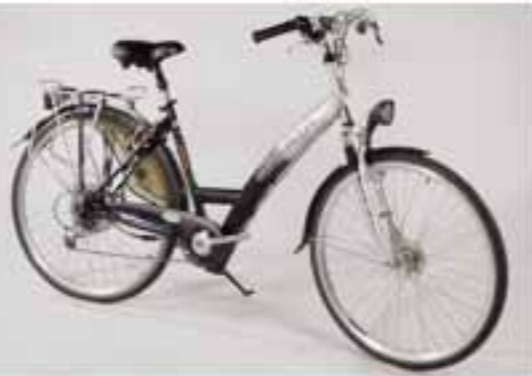
Der U-Prototyp des Sparta Ion. Es ist bis heute das in Europa meistverkaufte Pedelec. Eben eine halbe Mio. Fahrzeuge sollen verkauft werden und viele davon noch heute im Betrieb sein. Das Sparta Ion sieht unscheinbar aus, ist aber innovativ. Es setzte die Idee der schwanenartigen Batterie von Hercules (1987) erstmals in Großserie um. Der wesentlichen Bauteil der Fahrradcomputer als Schlüssel, der elektronisch mit dem zeitlichen System gekoppelt war. Ein getriebenes Fahrzeug war so für den Fahrer sehr schwer geworden. Für das Fahrradland Niederlande und gleichzeitiges Konzept der Fahrradfabrik ist diese Peak von nicht zu unterschätzen.
