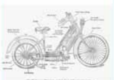
Technologisches und gestalterisches Meilenstein: das 1894 von Wolfmüller und Hildebrand in München inventierte und für 1000 Reichsmark angebotene Motorrad mit dem deutschen Kolbenventiltrieb in Form der heutigen Schutzbleche.
