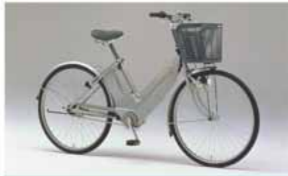
Das erste Pedelec in Produktion, das Yamaha PALS (Power Assist Law System), hatte einen Windkühlgetriebenen Motor, der über ein Ustrantrieb und ein Planetengetriebe im Tretlagerbereich steuerte. Das war notwendig um über die Abtriebs- die Muskelkraft messen zu können. Das Antriebssystem war sehr robust, hatte allerdings einen Sicherheitsdefekt: Es verschlängerte bei 20 W Motorleistung, so dass das Fahren ohne Antrieb zur Strafe wurde. Trotzdem erzielte es schon im ersten Jahr enormen Absatz.
