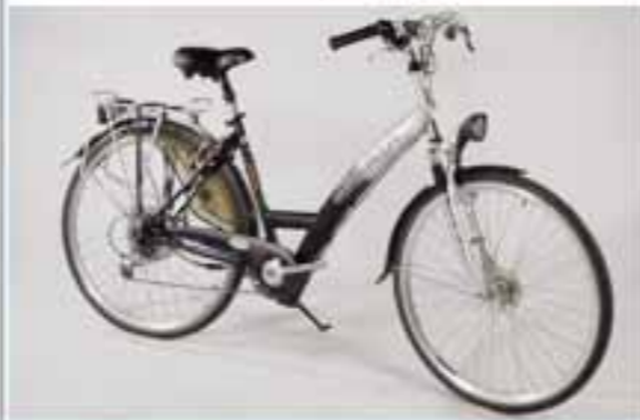
Der U-Prototyp des Sparta Ion. Es ist bis heute das in Europa meistverkaufte Pedelec. Eben eine halbe Mio. Fahrzeuge sollen verkauft werden und viele davon noch heute im Betrieb sein. Das Sparta Ion sieht unscheinbar aus, ist aber innovativ. Es setzte die Idee der schwanenartigen Batterie von Hercules (1978) erstmals in Großserie um. Der wesentlichen Bauteil der Fahrradcomputer als Schlüssel, der elektronisch mit dem zeitlichen System gepaart war. Ein getriebenes Fahrzeug war so für den Fahrer sehr schwer geworden. Für das Fahrradland Niederlande und gleichzeitiges Konzept der Fahrradfabrik ist diese Technik nicht zu unterschätzen.
