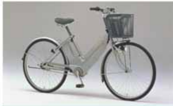
Das erste Pedelec in Produktion, das Yamaha P.A.S. (Power Assist System), hatte einen Windgetriebenen Motor, der über ein Urmotor- und ein Planetengetriebe im Tretlagerbereich steuerte. Das war notwendig um über die Abtriebs- die Muskelkraft messen zu können. Das Antriebssystem war sehr robust, hatte allerdings einen Sicherheitsdefekt: Es verschlängerte bei 20 W Motorleistung, so dass das Fahren ohne Antrieb zur Strafe wurde. Trotzdem erzielte es schon im ersten Jahr enormen Absatz.
