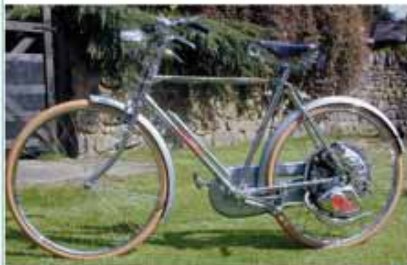
Ein Fahrrad mit Cyclemaster Verbrennungsmotor trübte Tank in der Hinterradbe-reich-Großstutzen – ein Zeugnis des Zeitalters der Mechanik, in dem man keine Kom-plexität scheute.
