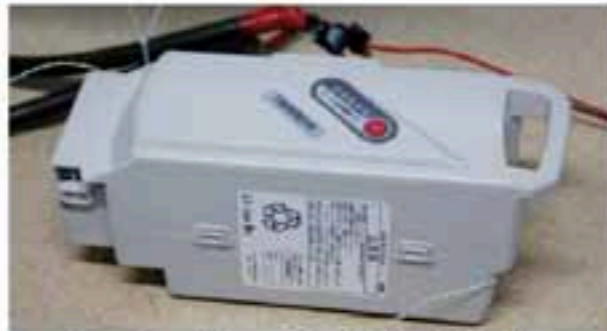
SICHERHEIT Das BMS (Battery Management System) schaltet schnell ab. In der zweiten Phase wurde die Elektronik überbrückt. So erhöhte sich die Batterie intern auf über 100 Grad Celsius, kühlte dann aber wieder ab. Es trat lediglich etwas Electrolyt-Flüssigkeit aus, aber keine Gase oder Flüssigkeiten.
