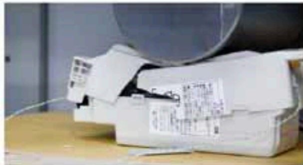
SICHERHEIT Mechanische Zerstörung des Batteriegehäuses, Quetschung der Zellen aber keine Erwärmung, kein Austritt von Gasen oder Flüssigkeiten.
