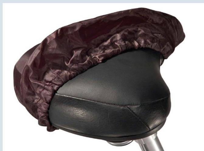
**LINKS** Unter dem Gepäckträger ist nicht nur die Batterie, sondern auch die Motorsteuerung zu Hause. **RECHTS** Praktisches Detail: aus dem Sattel lässt sich die Regen- und Dreckschutzhülle herausziehen und nach Gebrauch wieder in einem Schlitz verstauen.
